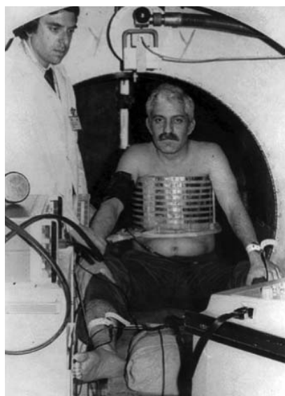
Рис. 2. Первый МРТ-аппарат Р. Дамадьяна во время испытания
